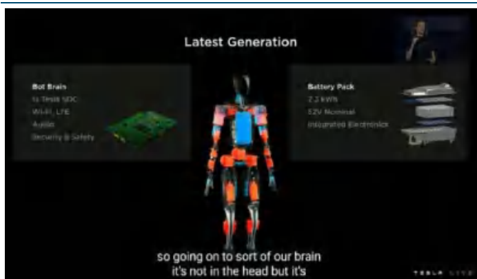
图表8: Optimus 躯干内部搭载 2.3kWh 的电池组
