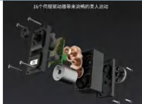
图表60: 优必选 Alpha Ebot 搭载 16 个伺服电机
