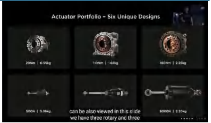
图表5: Optimus 采用 6 类执行器
