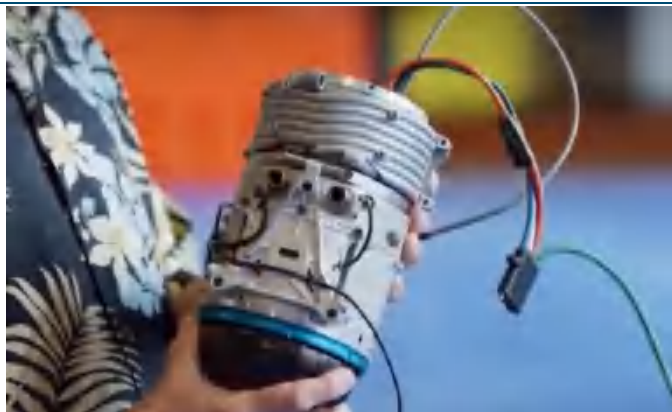
图表22: Atlas 液压驱动装置
