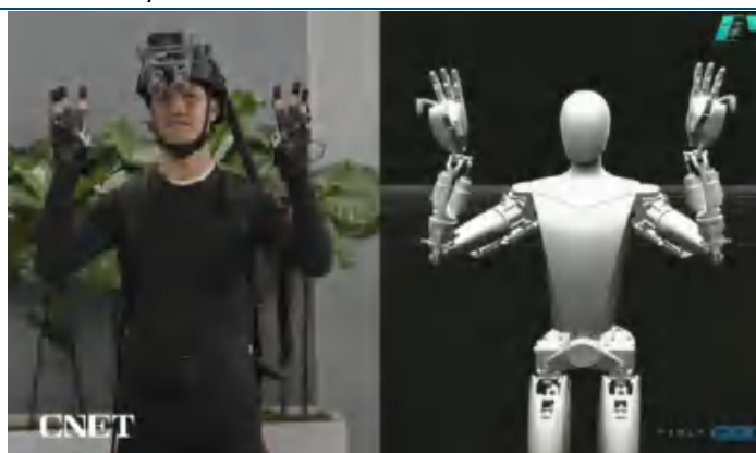
图表15: Optimus 可根据动作范例进行端到端动作操控
