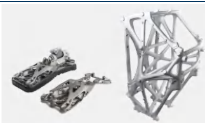
图表24: Atlas 人形机器人 3D 打印的零部件
